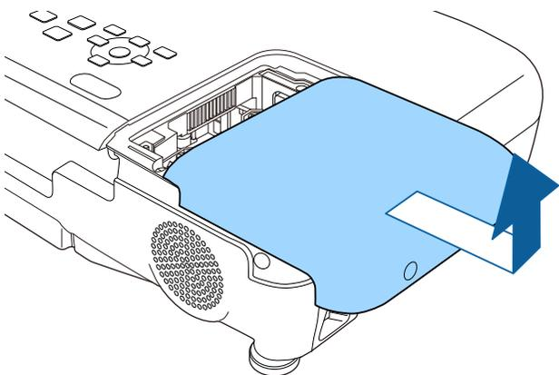
**5** 鬆開將燈泡固定至投影機的螺絲。不要完全拆下螺絲。
