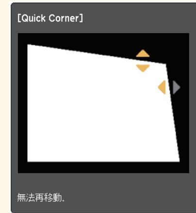
· 若要重設 Quick Corner 修正，請在顯示 Quick Corner 調整畫面時按住 [Esc] 大約 2 秒，然後選擇重設 **Quick Corner**。選擇切換至水平/垂直梯形修正，將影像形狀修正方式切換至水平/垂直梯形修正。
