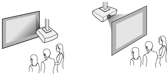
根據您所使用的安裝方式，請從投影機擴展選單選擇正確的投影方式選項。
